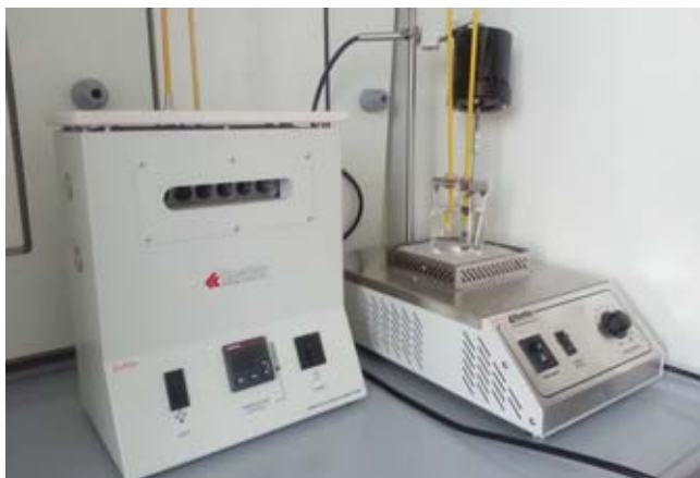
Апарати за определяне температура на прокапване на смазки – ляво в широк температурен диапазон – над 300°C – дясно – до 260°C
